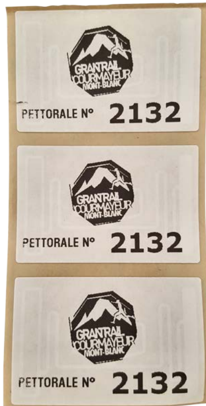
Figura 1 | Esempio di TAG RFID UHF fornito da Eurosintex.
